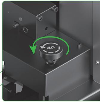
(1) 右のフィクスチャーノブを反時計回りに回します。
