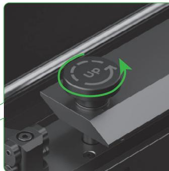
(4) 左側のフィクスチャーノブを反時計回りに回します。
